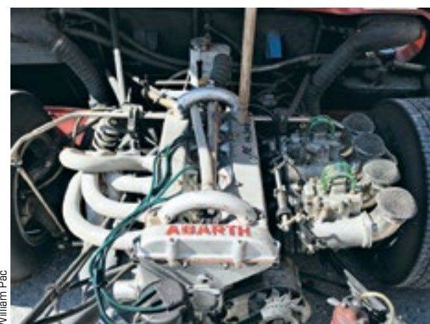
L'architecture typique du moteur quatre cylindres de l'Abarth, en porte-à-faux arrière.
